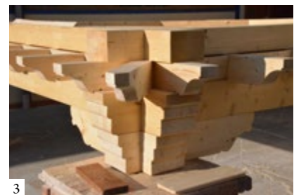
1: Carpentry workshop at the León Trades Center. Building of one slope of the new porch roof. Structural carpentry course, summer 2020 2: Workshop assembly of the new porch roof structure 3: Corner detail of the top plating for the new main porch structure, with footings, sill plates, beams, wall plates, and a corner crosspiece | 1: Taller de carpintería del Centro de los Oficios de León. Construcción de un faldón de la nueva armadura del pórtico sobre la entrada principal. Curso de carpintería de armar, verano de 2020 2: Montaje en el taller de la nueva armadura del pórtico principal para la iglesia de Santiago Apóstol 3: Detalle de la esquina del estriado de la nueva armadura del pórtico principal, con zapatas, soleras, cabezuelas, estribos y cuadral | 1: Oficina de carpintaria do Centro de Ofícios de León. Construção de uma das águas do novo telhado do pórtico. Curso de carpintaria estrutural, verão de 2020. 2: Montagem na oficina da nova estrutura do pórtico principal para a igreja de Santiago Apóstol. 3: Pormenor do canto do pilar do novo reforço do pórtico principal, com sapatas, soleiras, vigas, frechais e escoras
