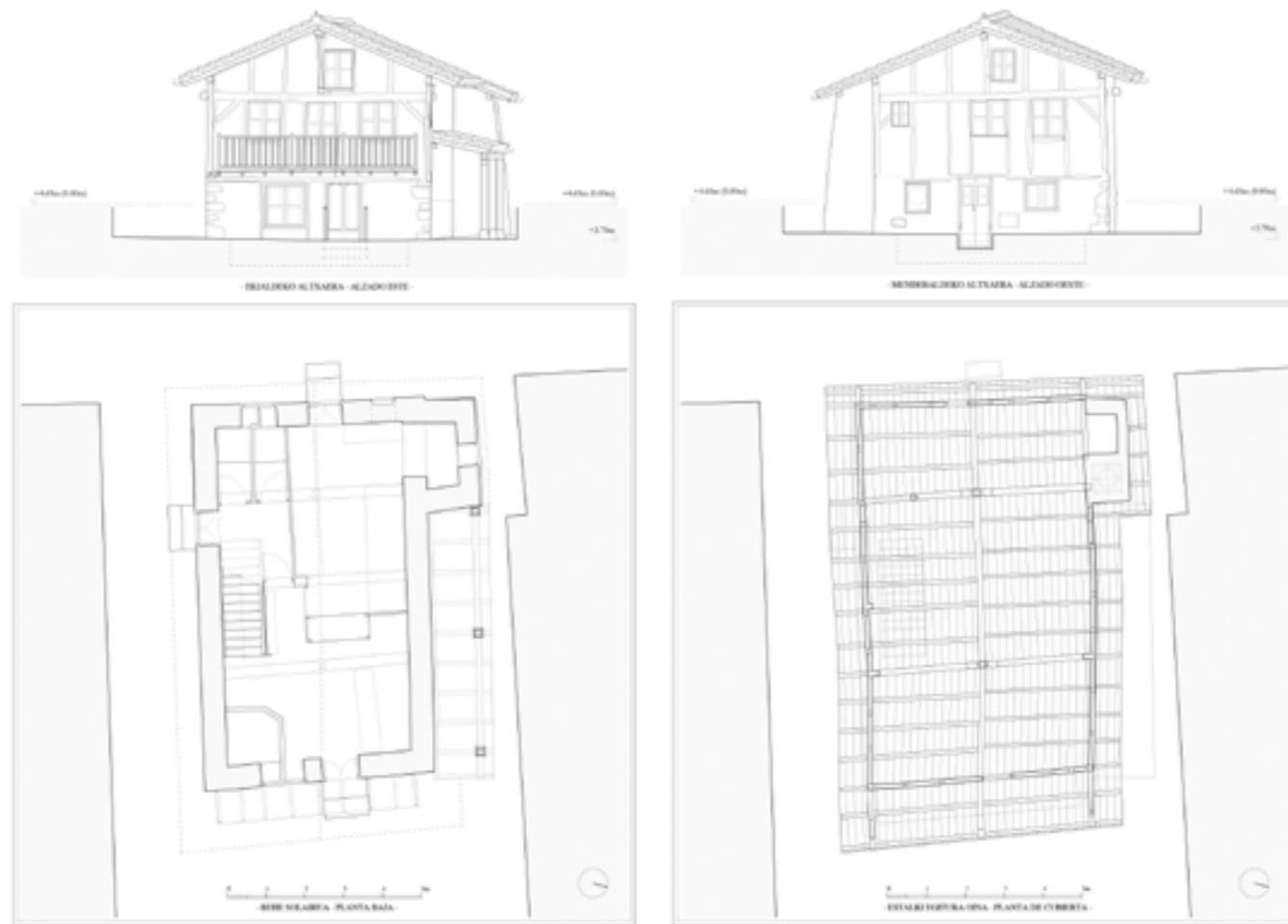
Figura 9: Levantamiento planimétrico del estado actual de la Casa Zeria. Planta baja con la fachada principal y planta primera con la fachada posterior.
