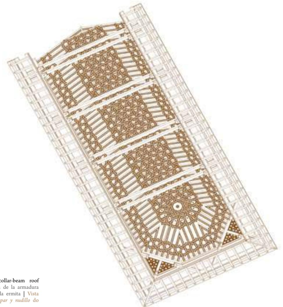
Axonometric view of the collar-beam roof structure | Vista axonométrica de la armadura de cubierta de par y nudillo la ermita | Vista axonométrica da armação de *par y nudillo* do telhado
