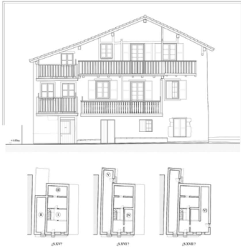
Figura 13: Alzado y esquema evolutivo de las casas n. 71 y n. 73 de la calle Santiago, situadas en el centro del arrabal.
