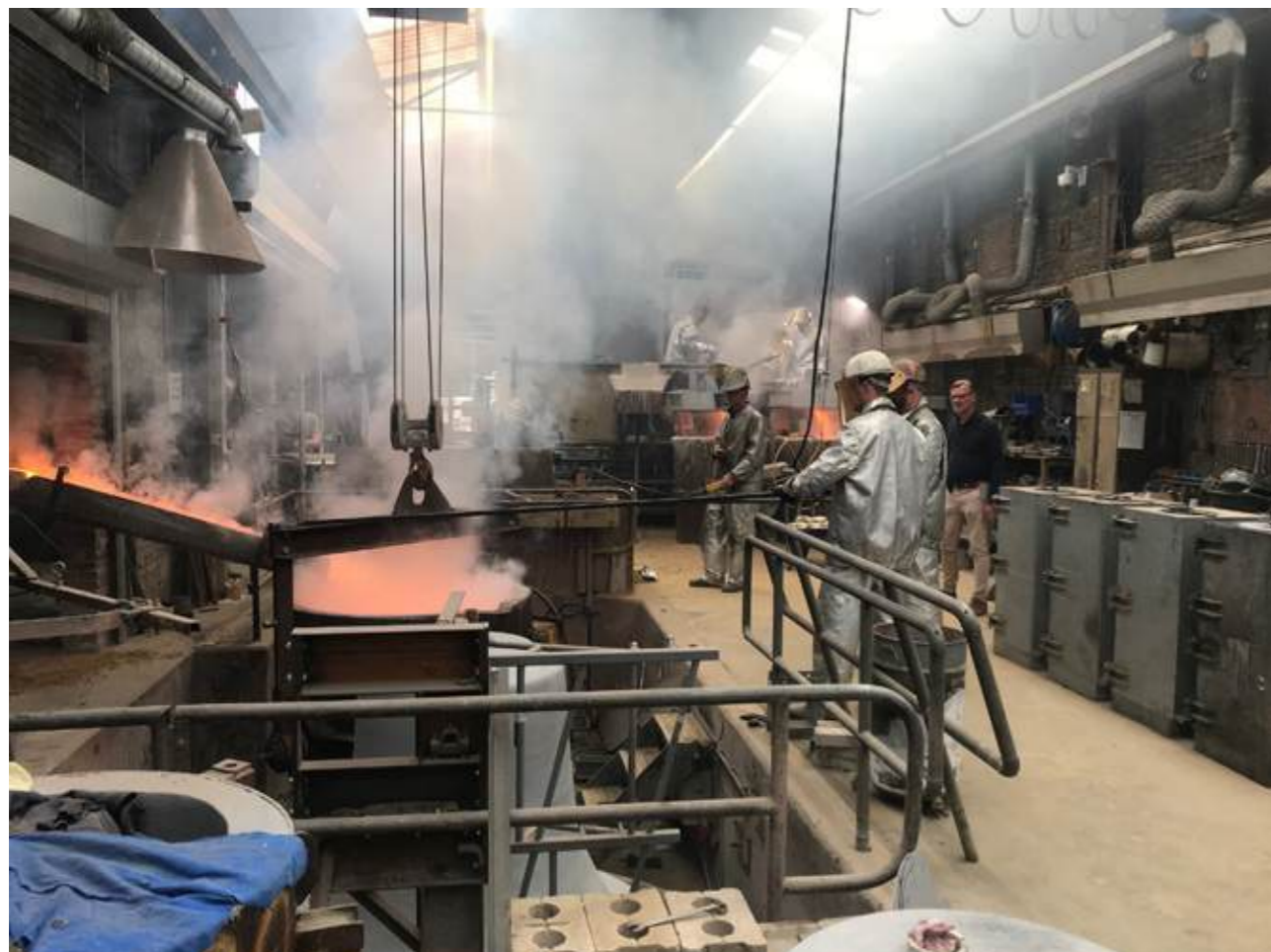
Bell-casting process | Proceso de fundición de la campana | Processo de fundição do sino (Eijsbouts)
