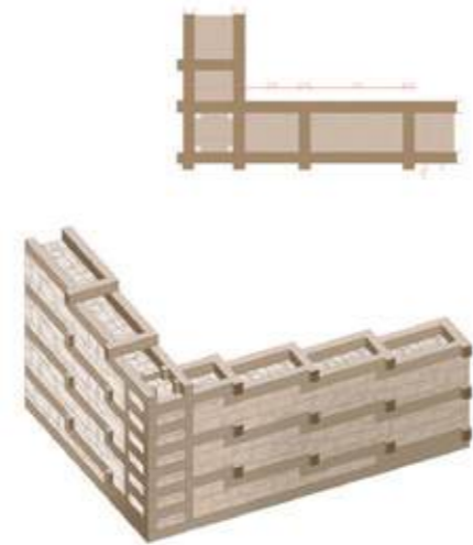
The earthquake-resistant dry-stone and timber system | Sistema sismorresistente construido con piedra seca y madera | Pormenor do sistema de pedra seca e madeira da Cidadela, resistente a terremotos
