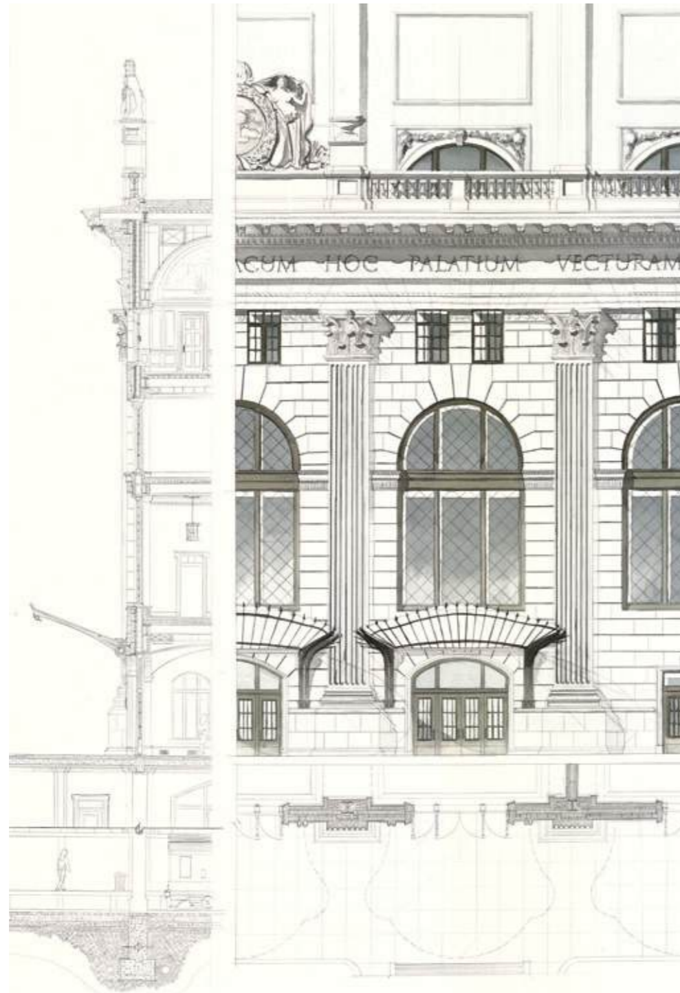
Alzado y sección típicos de un muro de la Estación de Pensilvania, Nueva York. Realizado por Andrew Califano. Profesor David Mayernik. 2015
