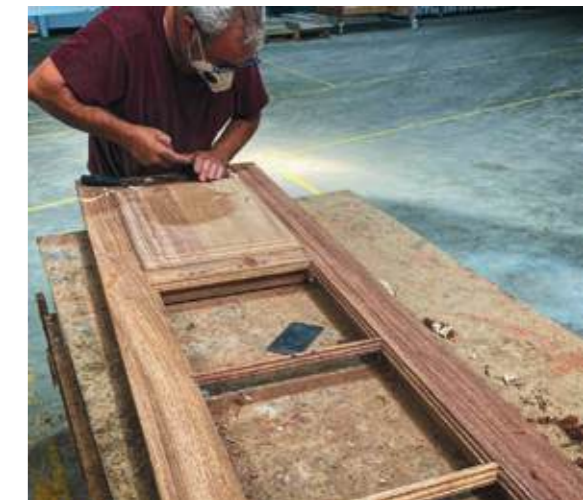
Restoration of window frames: survey and designs; execution of restorations and replicas | Restauración de los marcos de las ventanas: estudio y diseños; ejecución de restauraciones y réplicas | Processo Artesanal de Recuperação das Caixilharias, e Execução de Réplica das pré-existentes
