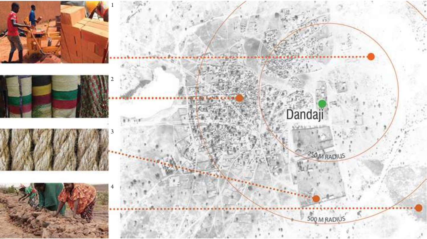
Map showing the sourcing radius of materials: 1. Compressed earth blocks made on site 2. Mats for privacy screens 3. Ropes for partitions 4. Stone for trenches and foundations | Mapa de radio de obtención de los materiales 1. Bloques de tierra comprimida elaborados in situ 2. Esteras para paneles de privacidad 3. Cuerdas para tabiques 4. Piedra para zanjas y cimientos | Mapa do raio de obtenção dos materiais: 1. Blocos de terra comprimida produzidos no local 2. Esteiras para painéis de privacidade 3. Cordas para divisórias 4. Pedra para valas e fundações
