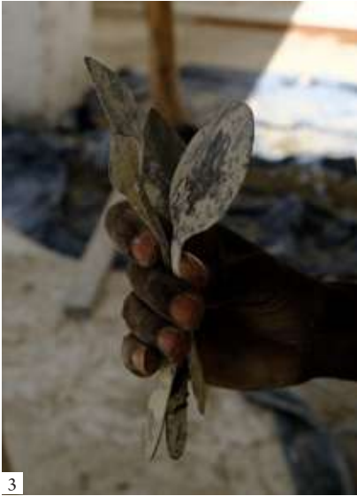
1: Swahili decorative work on traditional niches 2: Swahili decorative work on moldings 3: Tools, including spoons, used for decorative work | 1: Trabajos decorativos suajilis en nichos tradicionales 2: Trabajos decorativos suajilis en molduras 3: Herramientas, incluyendo cucharas, para los trabajos decorativos | 1: Trabalhos decorativos suailis em nichos tradicionais 2: Trabalhos decorativos suailis em molduras 3: Ferramentas, incluindo colheres, usadas nos trabalhos decorativos
