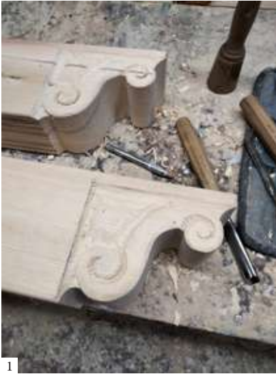
1: Support corbels for the eaves made by Miguel Ángel Balmaseda 2: Restoration of the brickwork in the spandrel 3: Process of cobbling and paving the open carriage porch | 1: Ménsulas de apoyo del tejazoz realizadas por Miguel Ángel Balmaseda 2: Restauración del ladrillo de la enjuta 3: Proceso de empedrado y enchinado del apeadero descubierto | 1: Mísulas de suporte do beiral executadas por Miguel Ángel Balmaseda 2: Restauo do tijolo na enjuta 3: Processo de empedramento e calçada da cocheira descoberta (1: Miguel Ángel Balmaseda 2: Sebastián Pérez Gómez 3: Urbipac)
